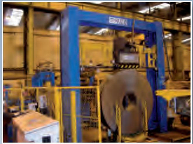
Flejadora con cabezal vertical para el flejado circunferencial de bobinas cortadas con fleje de acero.
