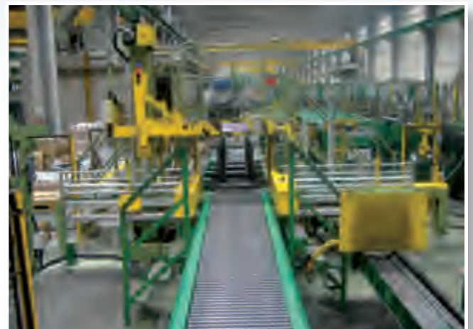
Flejadora para el flejado transversal de paquetes de tubos con fleje de acero de 32mm e incorporación de los tacos de madera en modo automático.
