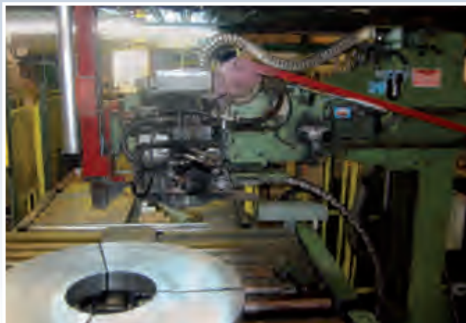
Flejadora TITAN para el flejado radial de bobinas con fleje de acero de 19mm.
