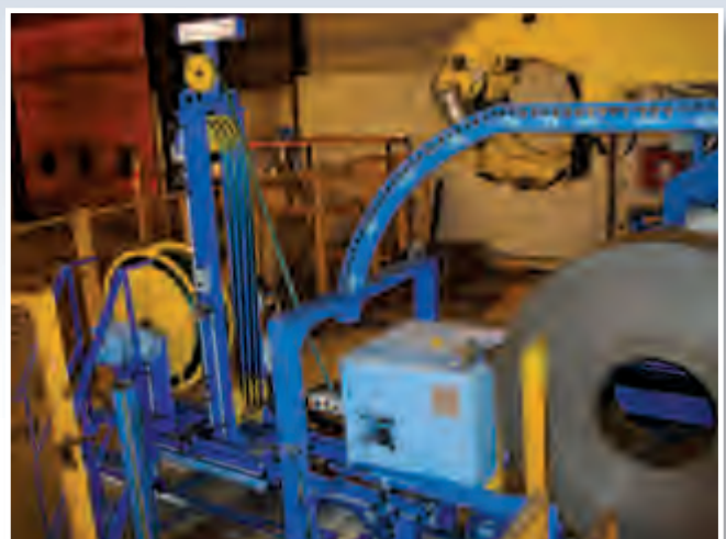
Flejadora con cabezal horizontal para el flejado circunferencial de bobinas con fleje de poliéster, colocada en una línea de decapado.
