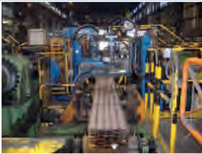
Vista general de dos flejadoras automáticas para el flejado transversal de paquetes de perfiles con fleje de acero de 32mm.
