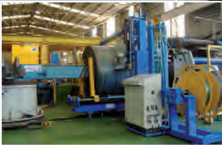
Flejadora para el flejado circunferencial de bobinas en frío, con fleje de poliéster de 32mm.
