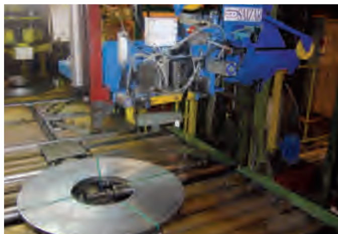
Flejadora TITAN para el flejado radial de bobinas, con cabezal SAIZAR CASP-19 para fleje de poliéster de 19mm
