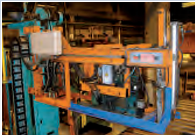
Flejadora SIGNODE para el flejado radial de bobinas con fleje de acero de 19mm
