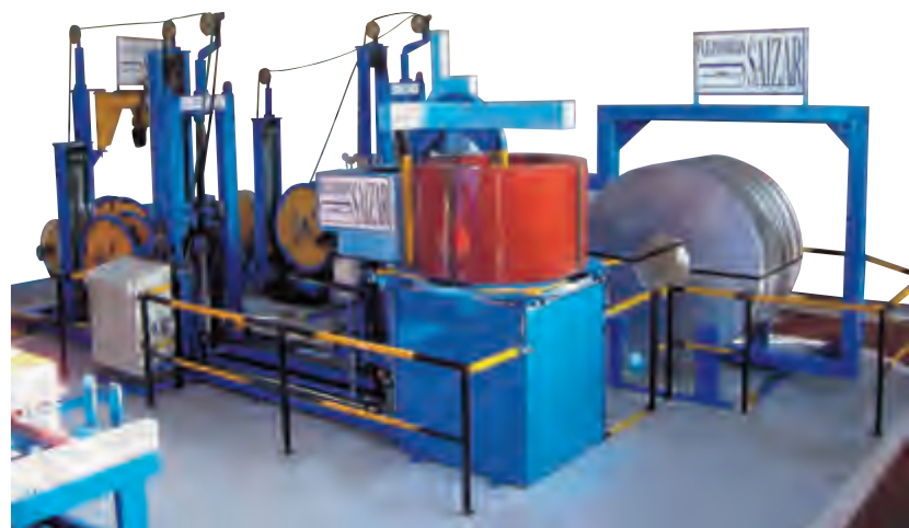
Flejadoras automáticas para el flejado circunferencial y radial de bobinas (con incorporación de anillas en automático) con fleje de acero y poliéster.
