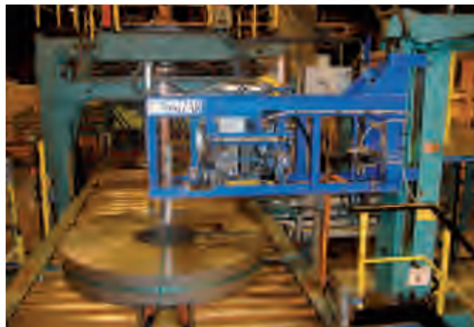
Flejadora SIGNODE para el flejado radial de bobinas, con cabezal SAIZAR CASP-32 para fleje de poliéster de 32mm
