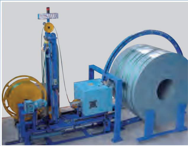
Flejadora para el flejado circunferencial de bobinas en frío con fleje de poliéster 32mm.
