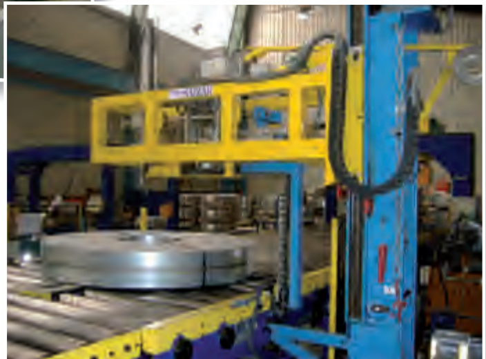
Flejadora para el flejado radial de bobinas con fleje de acero de 19mm
