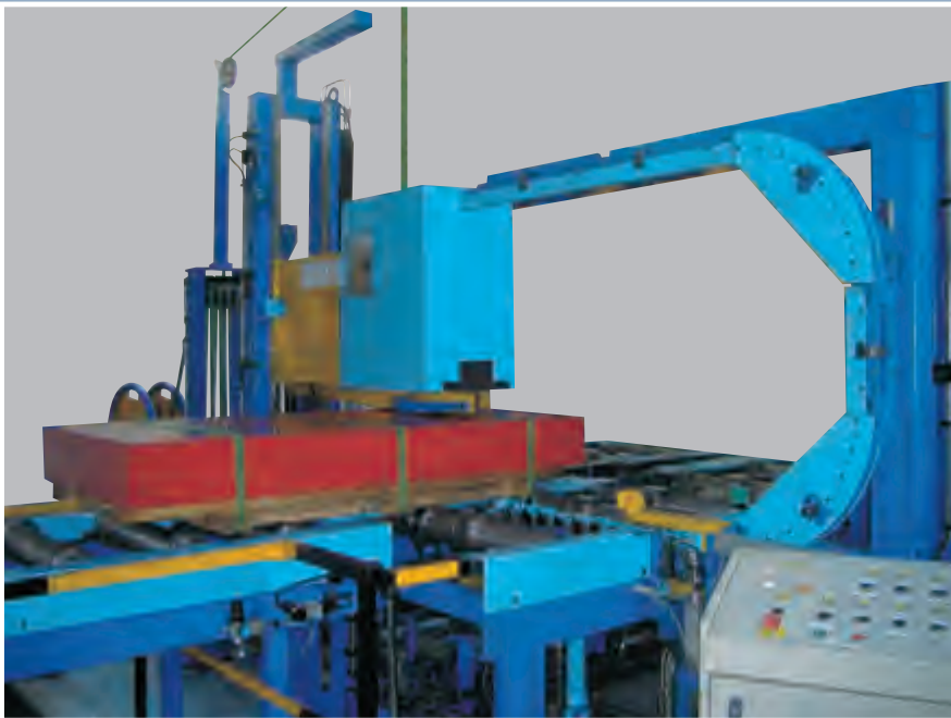
Flejadora en posición de flejado transversal de paquetes con fleje de poliéster de 32mm.
