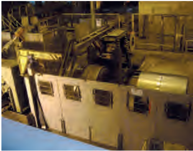
Flejadora en posición de flejado circunferencial de bobinas en caliente, con fleje de acero de 32mm.
